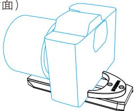
照相机安装了长焦镜头或镜头脚架环，快装板采用前装的方式。(如意固定座在相机前方)
