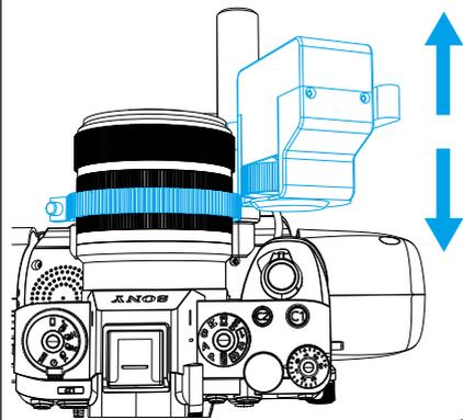
第10步：将镜头变焦调节器与照相机镜头安装的变焦环齿轮紧密咬合
