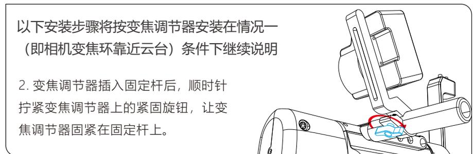
**第4步：在照相机变焦镜头上安装变焦环**
