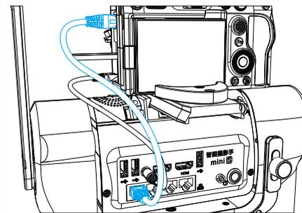
注意：云台上的有4个网线插口，插入前三个都可以，但建议插入左边的第一个。
