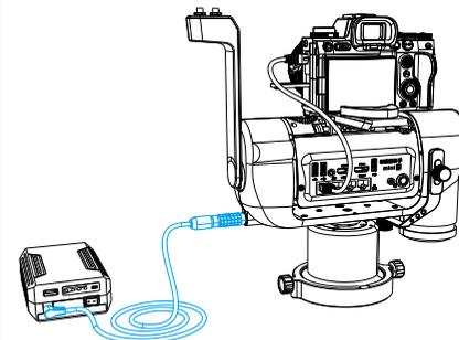
注意：电源线接入云台电源接口时，接口有方向标识需要对齐才可以插入。
