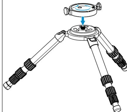
2. 根据现场拍摄需要的方向，按照拍摄方位座上指示的方向将三脚架摆放好，并观察水平气泡仪调整好水平。
