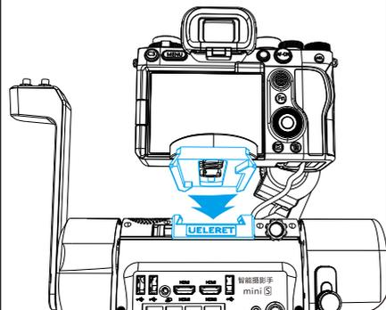
3. 顺时针旋紧快装板手拧螺母，让快装板固定位置不滑动。
