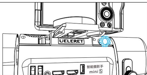
**第6步：安装相机电池转换器**
