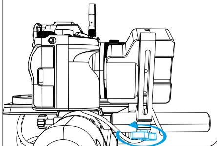
(2). 按图示方向将镜头变焦调节器齿轮与变焦环齿轮啮合。
