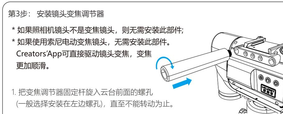
注意：镜头变焦调节器根据镜头变焦环距离云台的距离不同有两种不同的安装方法
