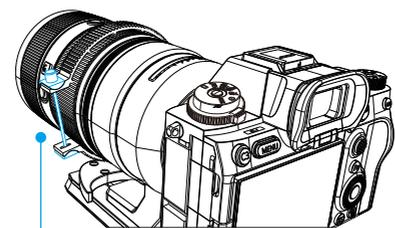
使用如意快装板时，变焦环的固定旋杆需要安装在镜头的左侧（右侧为变焦调节器），变焦时不会与快装板干涉
