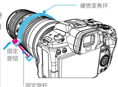
使用如意快装板时，变焦环的固定旋杆需要安装在镜头的左侧（右侧为变焦调节器），变焦时不会与快装板干涉
