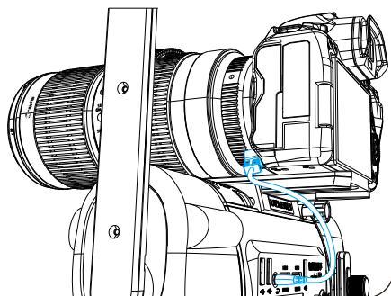
(4). 数码相机电池转换器连接线的安装，具体步骤参见第一章第7点的电池转换器安装说明（如果用数码相机原装电池则不需要本步骤）。
