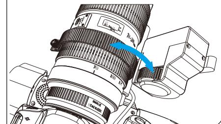
**注意：**需要用手指压住镜头变焦调节器上的金属杆，让两个齿轮啮合紧密再旋紧手拧旋钮，如果是压住塑料盒，可能会导致咬合不紧。
