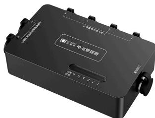
假如一共连接了3块电池，在第1块、第2块电池用完，开始进入第3块电池的使用。此时取下第1块电池用于充电。充电结束后，连接在电池管理器的第一个电源口。当第3块电池使用结束，会自动跳回到第1块电池开始使用。
