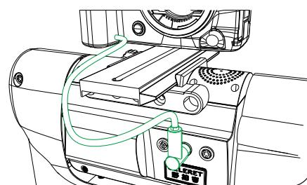
(5). 镜头变焦器电源线，接入云台前面板的电源插口，位置见示意图，在左边的第一个。
