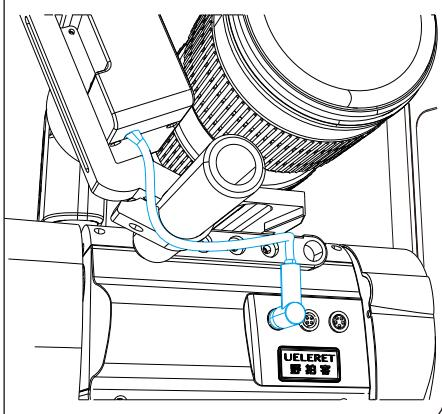
(6). 标配电池的电源线，一端接入云台侧面的电池接口，另一端插入标配电池的24V输出口。
