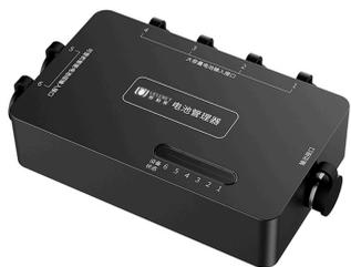
假如一共连接了3块电池, 在第1块、第2块电池用完, 开始进入第3块电池的使用。此时取下第1块电池用于充电。充电结束后, 连接在电池管理器的第1个电源口。当第3块电池使用结束, 会自动跳回到第1块电池开始使用。
