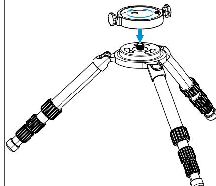
2. 根据现场拍摄需要的方向，按照拍摄方位座上指示的方向将三脚架摆放好，并观察水平气泡仪调整好水平。
