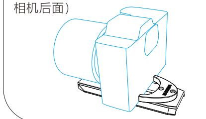
照相机安装了长焦镜头或镜头脚架环，快装板采用前装的方式。(如意固定座在相机前方)
