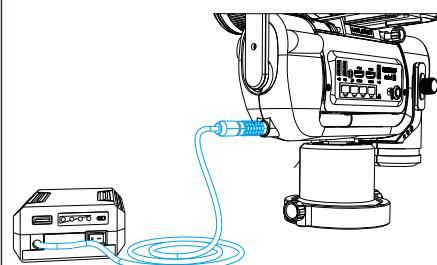
**注意：**电源线接入云台电源接口时，接口有方向标识需要对齐才可以插入。
