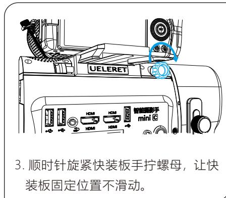
3. 顺时针旋紧快装板手拧螺母，让快装板固定位置不滑动。
