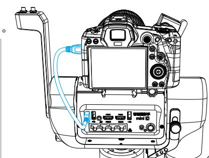
(3). 把快门线的一端插入数码相机的快门插口，另一端接入云台背板对应的快门插口。
