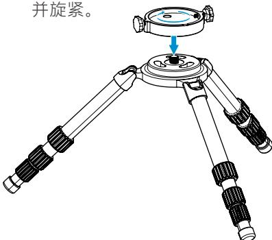
(2). 根据现场拍摄需要的方向，按照拍摄方位座上指示的方向将三脚架插入水中或泥中。并观察水平气泡仪调整好水平。
