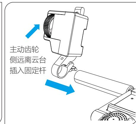
佳能的中短焦镜头，镜头变焦调节器根据镜头变焦环距离云台的距离不同有两种不同的安装方法
