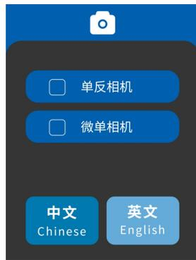
进入[逻辑盒]页面，首先选择安装的相机类型，选择单反相机或微单相机；数码相机是否可以休眠、LCD屏是否关闭，单反相机与微单相机在拍摄逻辑上是不同的。选择后，智拍宝会用对应的拍摄指令来满足数码相机不同设置时的状态。如果没有按照上述要求使用智拍宝，数码相机的拍摄可能出现紊乱，拍摄行动可能失败。
