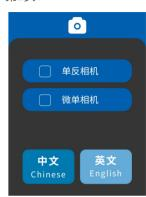
进入[逻辑盒]页面,首先选择安装的相机类型,选择单反相机或微单相机;数码相机是否可以休眠、LCD屏是否关闭,单反相机与微单相机在拍摄逻辑上是不同的。选择后,智拍宝会用对应的拍摄指令来满足数码相机不同设置时的状态。如果没按照上述要求使用智拍宝,数码相机的拍摄可能出现紊乱,拍摄行动可能失败。
