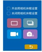
选项【开启照相机休眠】,指数码相机设置了可以休眠。当拍摄结束达到一定时间,数码相机的节电功能会让数码相机进入休眠状态。
