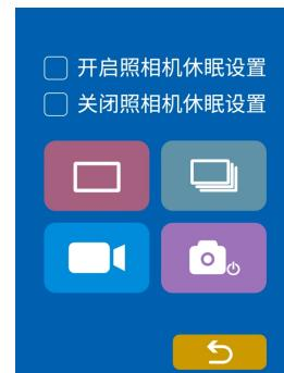
选项【开启照相机休眠】，指数码相机设置了可以休眠。当拍摄结束达到一定时间，数码相机的节电功能会让相机进入休眠状态。
