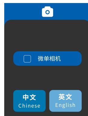
进入 [ 逻辑盒 ] 页面，首先选择安装的相机类型，选择单反相机或微单相机；数码相机是否可以休眠、LCD屏是否关闭，单反相机与微单相机在拍摄逻辑上是不同的。选择后，智能摄影盒会用对应的拍摄指令来满足数码相机不同设置时的状态。如果没有按照上述要求使用智能摄影盒，数码相机的拍摄可能出现紊乱，拍摄行动可能失败。
